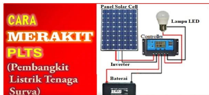
Gambar 4. Cara merakit komponen panel solar cell
